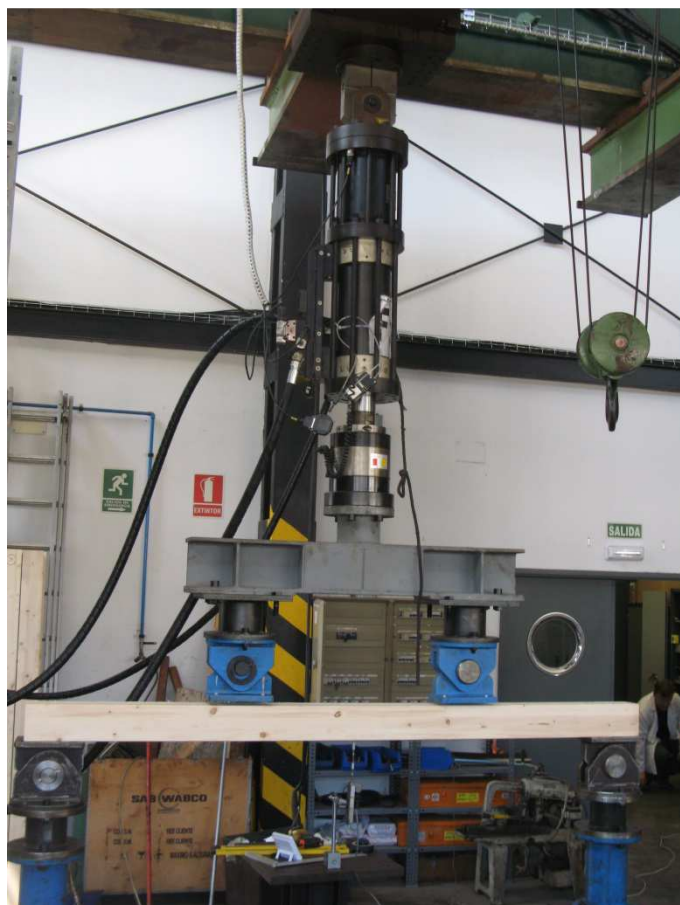
Fotografía 2. Máquina universal de ensayos para evaluación destructiva de madera (ensayo de resistencia a flexión). Estos ensayos destructivos casi nunca son posibles de realizar en madera antigua y patrimonial; para madera nueva suponen un coste muy elevado, así como desaprovechamiento del material.
